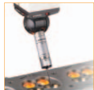
SP25M/PH10MQ – brzo i neprekidno uzimanje podataka
