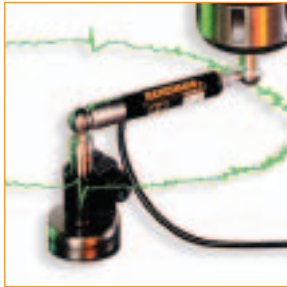
"Ballbar" – brzo testiranje učinka alatnih mašina
