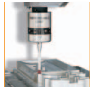
OMP40 – ultrakompaktne vretenaste merne sonde za podešavanje i pregled
