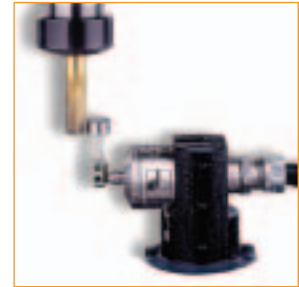
TS27R - po ceni povoljan, za podešavanje alata na mašini
